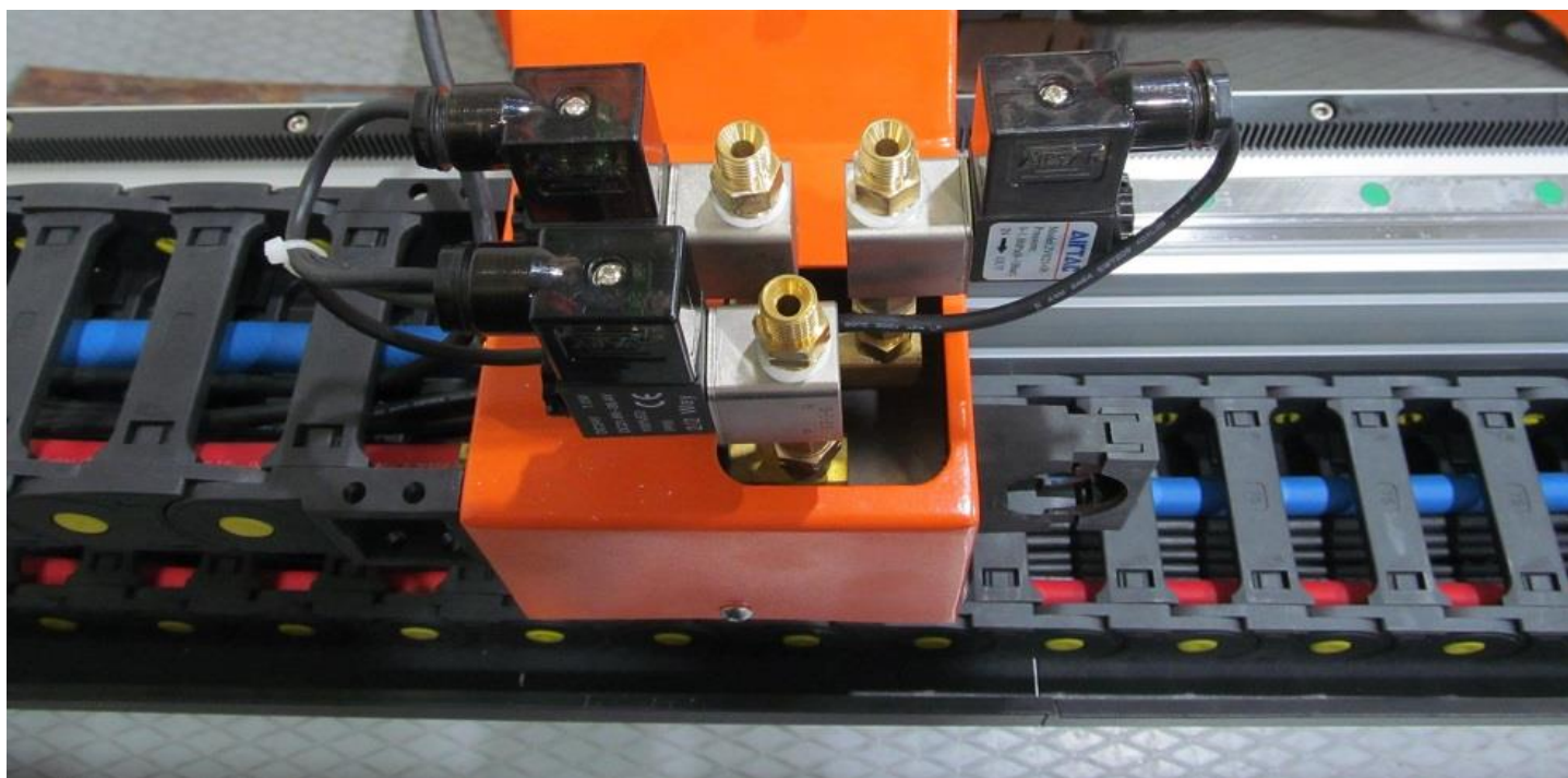
Рис.44 - Клапаны газовой резки.
