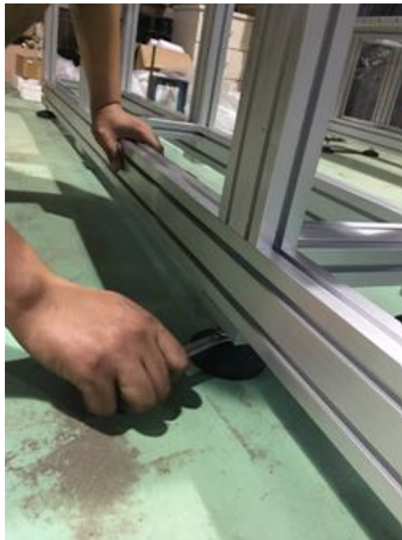
Рис.9 - Регулировка уровня стоек
