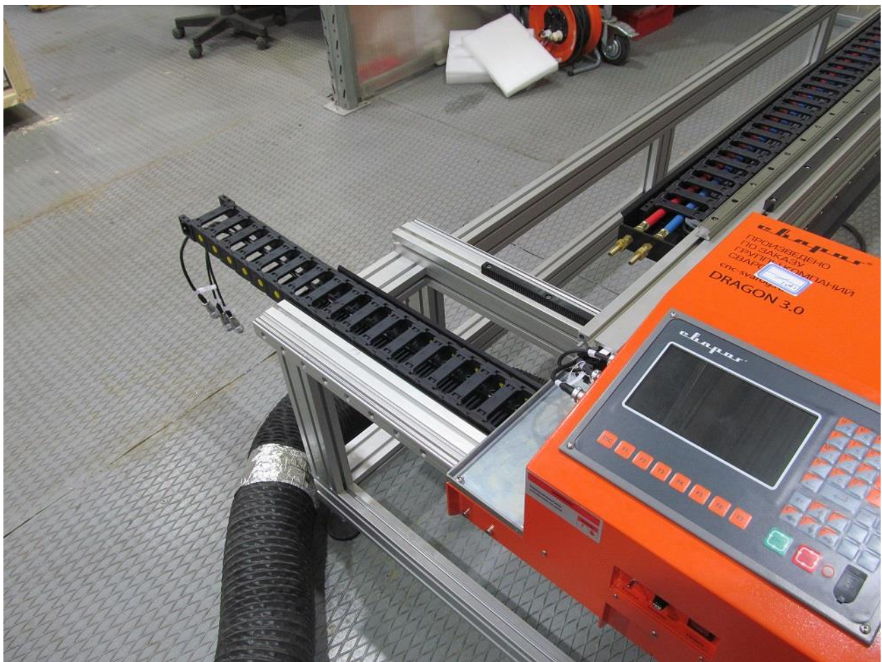
Рис.35 - Кабельный канал основного рельса
