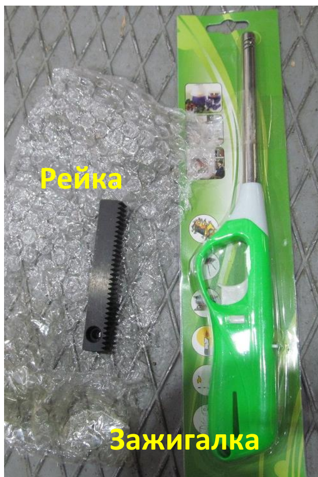
Рис.4 - Комплектующие станка. Регулировочная рейка. Зажигалка (для поджига газа). Декоративные заглушки (устанавливаются на торцах корпуса станка).
