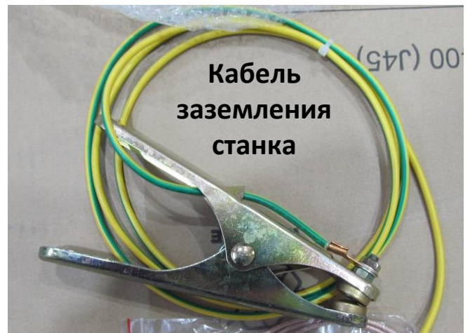
Рис.5 - Комплектующие станка. Фиксаторы стойки. Виброопоры. Винты крепления опор. Программное обеспечение FastCAM и USB flash disk. Запасное сопло для газового резака. Хомуты. Кабель заземления станка.
