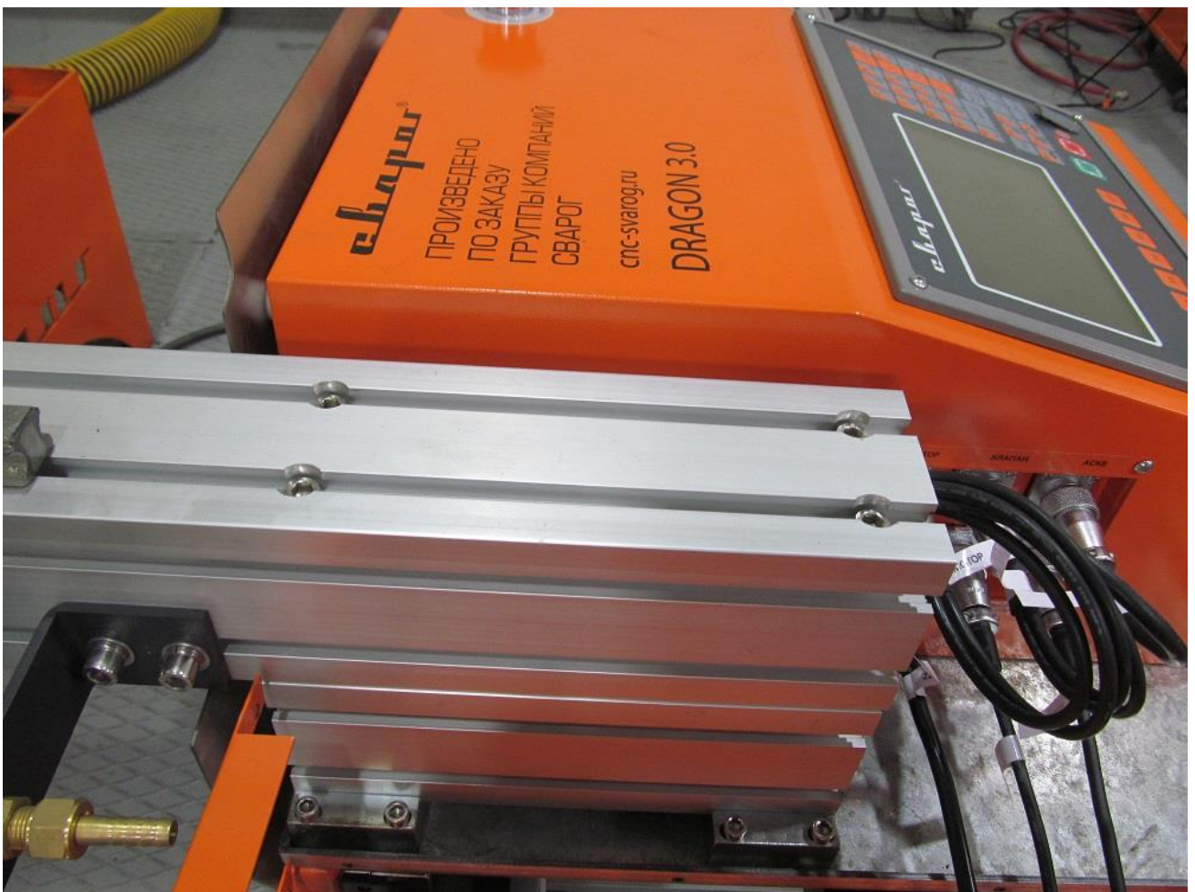
Рис.30 - Платформа блока управления с установленным поперечным рельсом (балкой)
