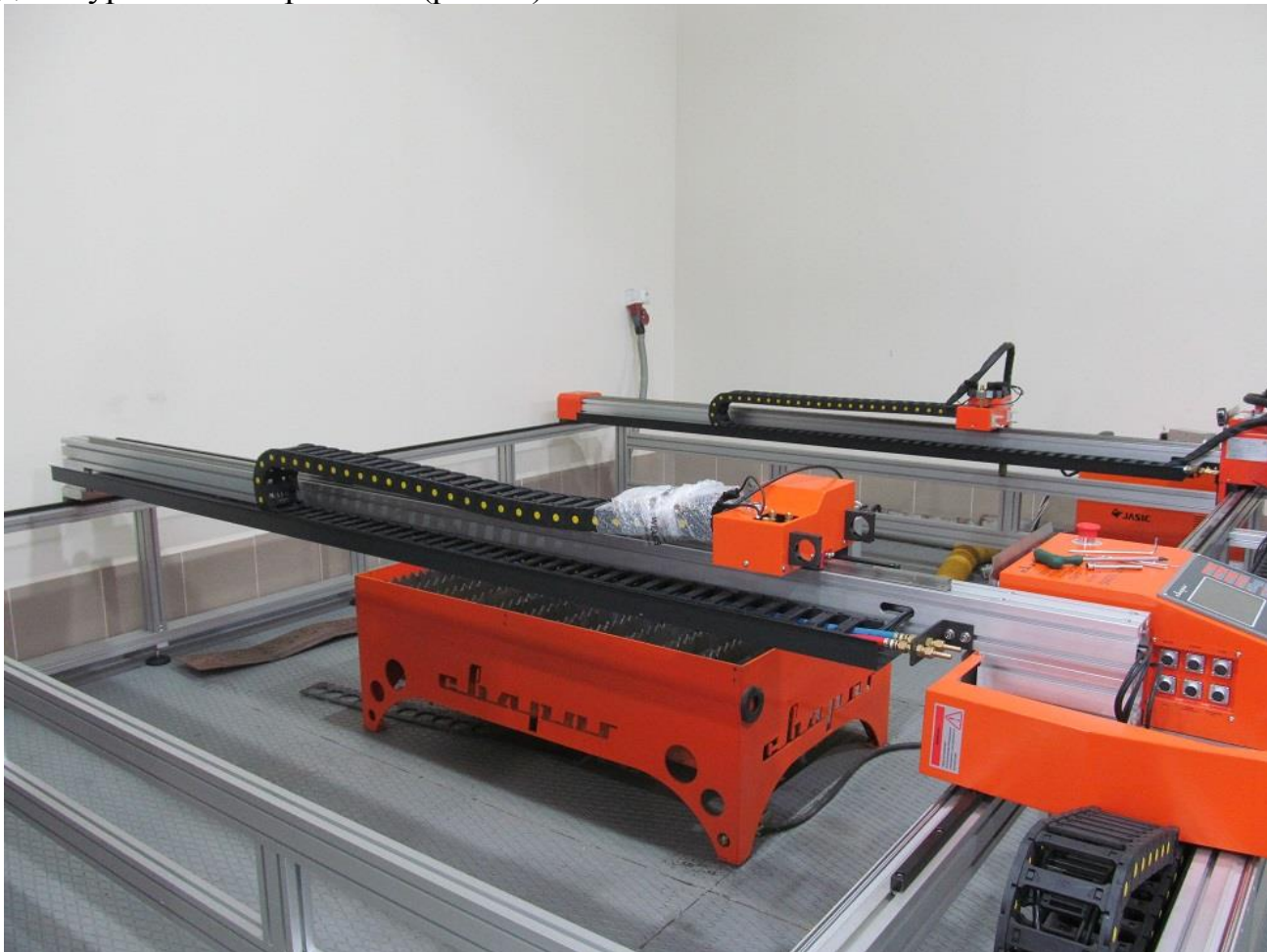
Рис.23 - Установка поперечного рельса
