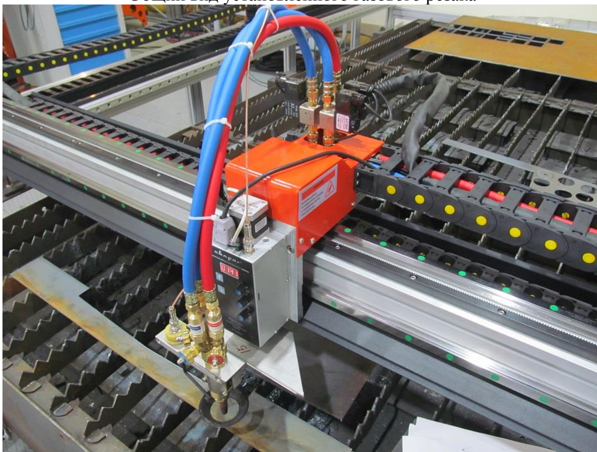
Рис.65 Общий вид установленного газового резака
