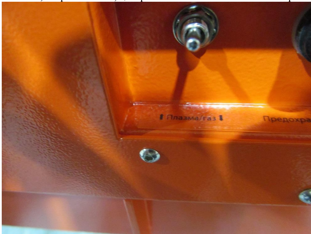
Рис.85 Тумблер переключения режимов работы Плазма/Газ
