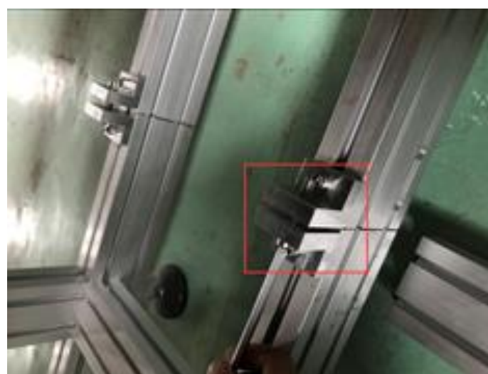
Рис.12 - Стыковка секций 6-ти метрового станка (2500x6000)
