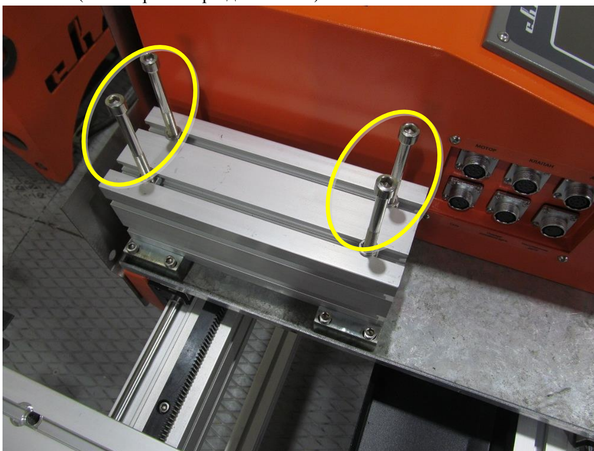
Рис.19 - Винты крепления поперечного рельса (балки)
