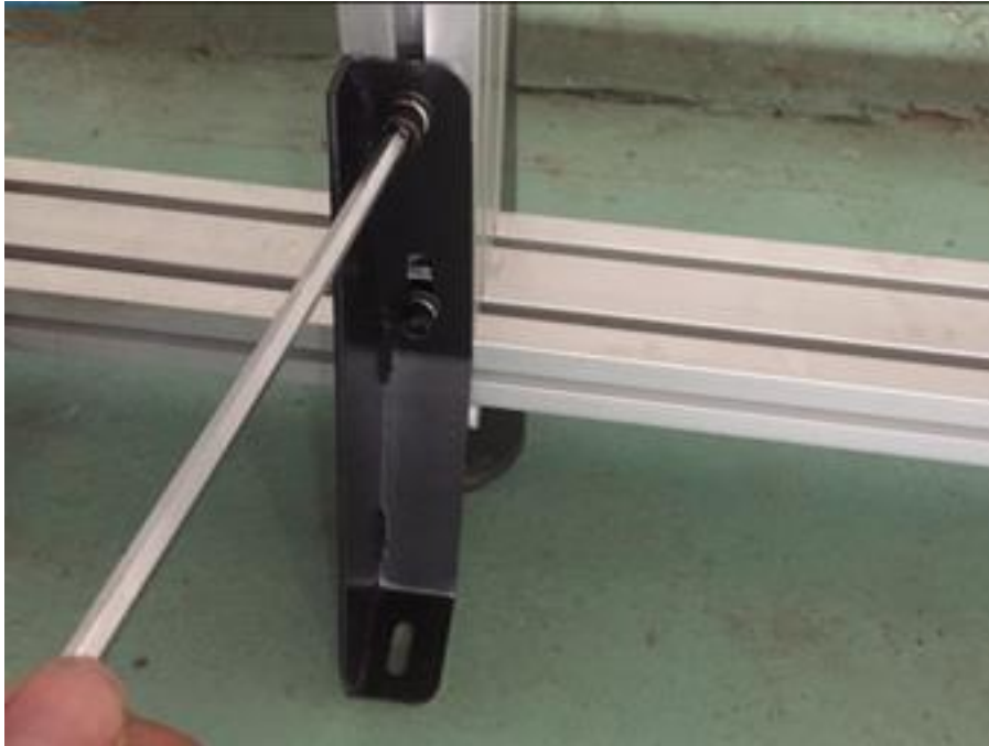
Рис.15 - Установка фиксаторов стоек
